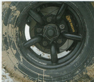
330 Millimeter große Bremsscheiben sorgen für ordentliche Verzögerung
