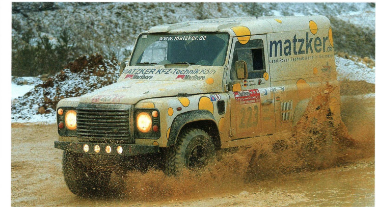
Der Aufbau des Rallye-Defender ist aus dünnem Blech gefertigt. Gewichtersparnis: 30 Kilo
