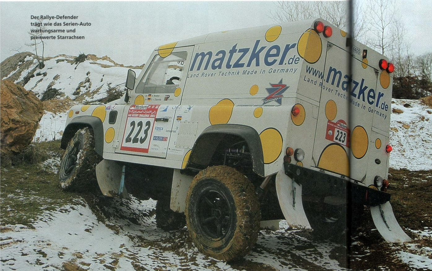
Der Aufbau des Rallye-Defender ist aus dünnem Blech gefertigt. Gewichtersparnis: 30 Kilo
